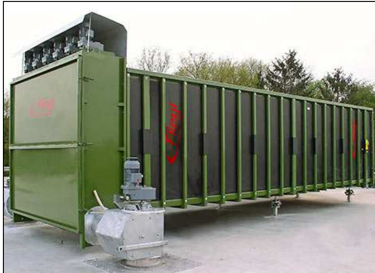
Exemple de trémie d'incorporation d'intrants solides
